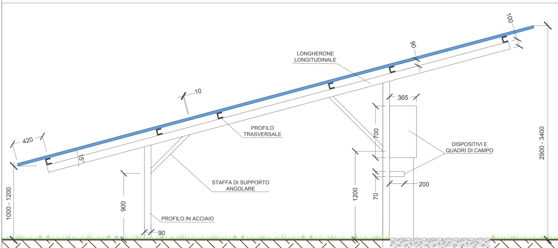
SEZIONE DELLA STRUTTURA DI SUPPORTO AI MODULI [mm] 1:20
